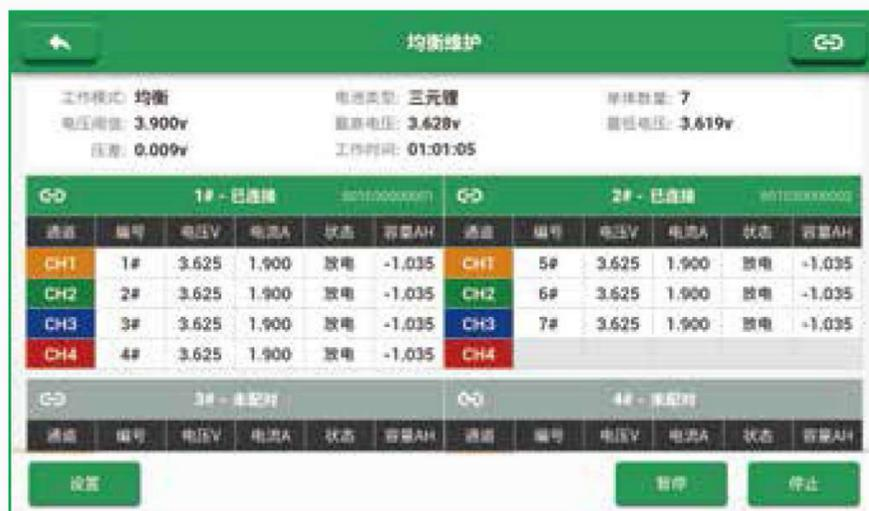
**WEB1224支持电池健康状态评估, 独有软件算法测算SOC/SOH值, 并自动保存历史均衡记录, 支持曲线图、柱图两种展示方式**
