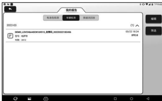
如在电池包检测过程中保存了检测报告，则报告会显示在“电池包检测”标签下；如在车辆检测过程中保存了检测报告，故障码报告和数据流报告，则报告会显示在“车辆检测”标签下。
