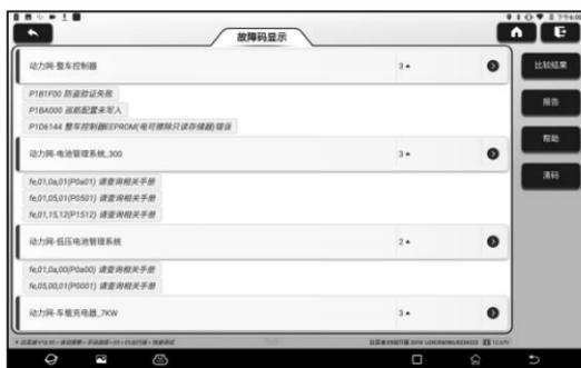
存在故障码的系统会以红色字体显示在屏幕上，并显示具体的故障码数量。无故障的系统（黑色）则显示为“正常”。
