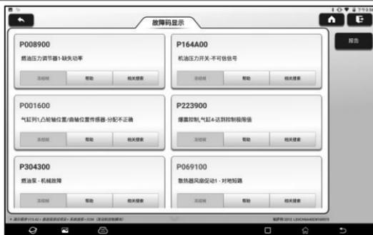
**警告：**在检修车辆故障时读故障码只是整个诊断过程中的一小步。车辆故障码只是作为参考，不能在给出的故障码定义的基础上直接更换零部件。每个故障码都有一套测试程序，维修技师必须严格按照汽车维修手册中所述的操作指示和流程来确认故障的根结所在。
