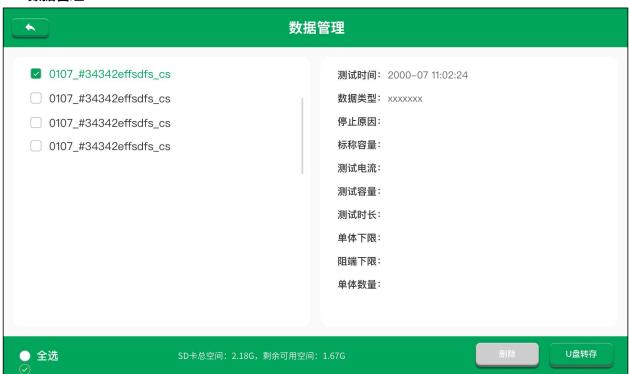
将U盘插入面板上USB口,择要保存的数据,点击U盘转存键可将对应的放电数据和充电数据转存至U盘。
