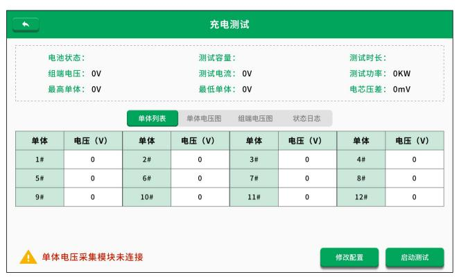
在测试的界面可以查看电池组当前状态,测试电流大小,测试时长,当前组端电压以及单体信息等。在测试过程中,可以修改配置。
