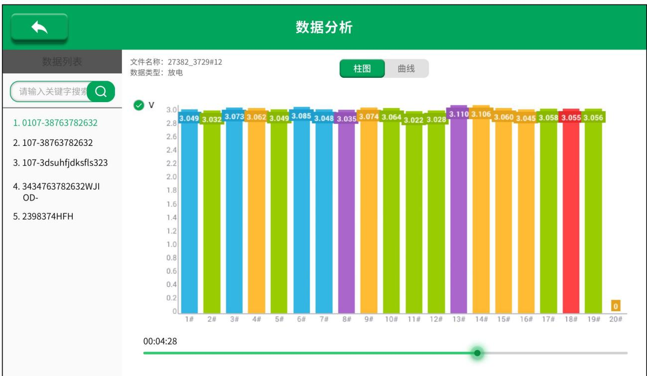
点击“曲线”测试数据电压以曲线图显示。
